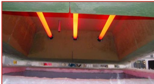
alto potere riflettente contenente tre barre scaldanti in carburo di silicio.
