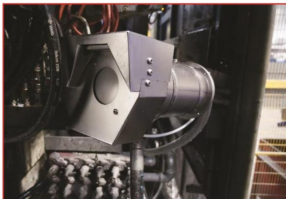
Il DeTector 4.0 è dotato di un software che acquisisce automaticamente singole immagini tramite comandi d'attivazione inviati dalla pressa cui è direttamente collegato.
